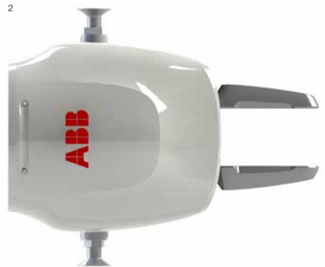
1. Рука с сервоприводом и один пневматический блок, с камерой | 2. Рука с сервоприводом и два пневматических блока с индикаторами состояния
