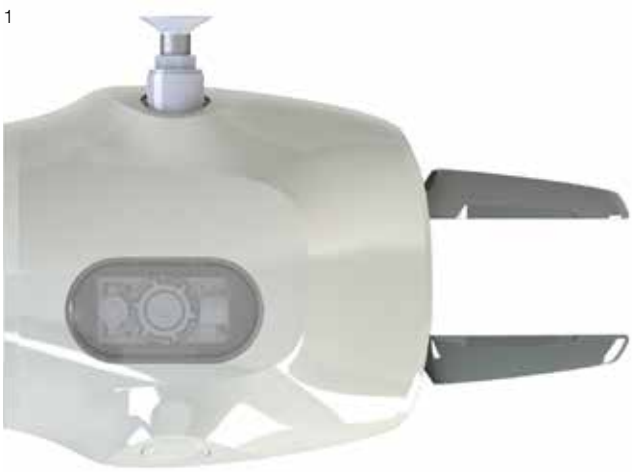
1. Рука с сервоприводом и один пневматический блок, с камерой | 2. Рука с сервоприводом и два пневматических блока с индикаторами состояния
